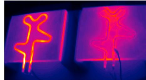
Die Aufnahme der Wärmebildkamera zeigt deutlich den besseren Wärmeübergang des mit dem GC-flex tool set eingebauten GC-flex D-shape (rechts) im Vergleich zu einem alternativen Heizer. Der GC-flex D-shape überhitzt nicht und das Werkzeug wird schneller aufgeheizt.
