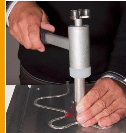
**4** Um einen optimalen Wärmeübergang zu gewährleisten, ist es notwendig, den GC-flex nach dem Einbiegen in der Nut ca. alle 20 mm zu fixieren (Bild F). Wie die Montage muss auch das Fixieren von der Mitte ausgehend durchgeführt werden. Dazu verwenden Sie bitte ein auf den Durchmesser Ihres GC-flex abgestimmtes Einschlagwerkzeug (GC-flex compression tool).
